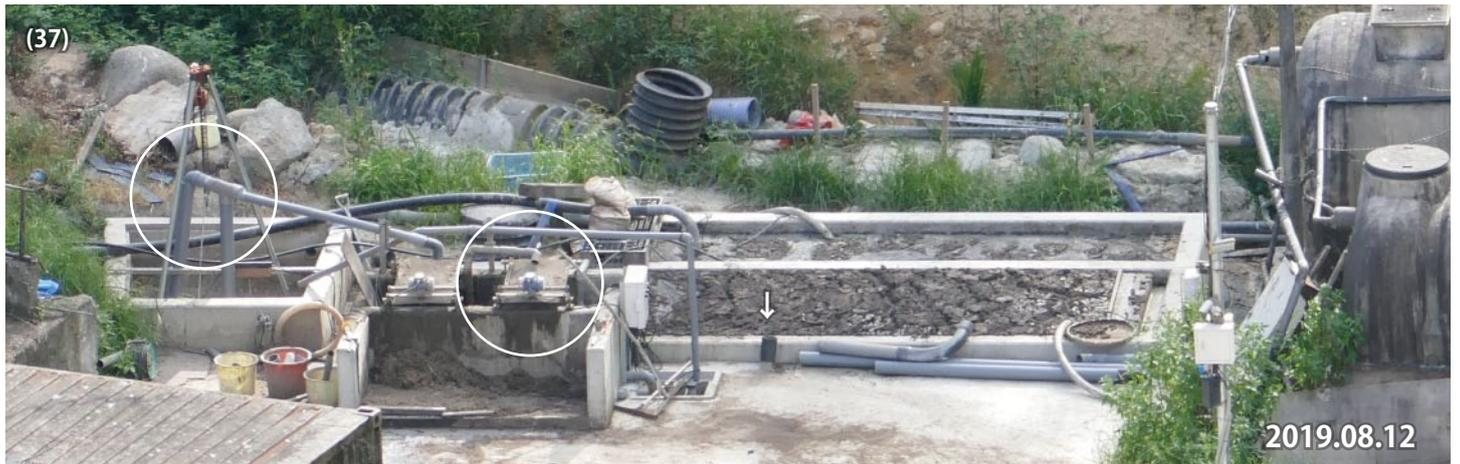
2019年8月初め頃、水路の暗渠管に差し込まれていたパイプが取り外され、二つ目の振動篩が再び取り付けられた。また縦穴から最初の振動篩へ伸びるパイプが太いものに交換された。
